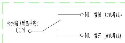
3. 当分配器带有接近开关循环指示器 ( 即循环开关 ) 时 , 请按以下示意图接线。( 附接近开关使
