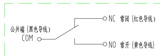
3. 当分配器带有接近开关循环指示器（即循环开关）时，请按以下示意图接线。（附接近开关使用说明书）
